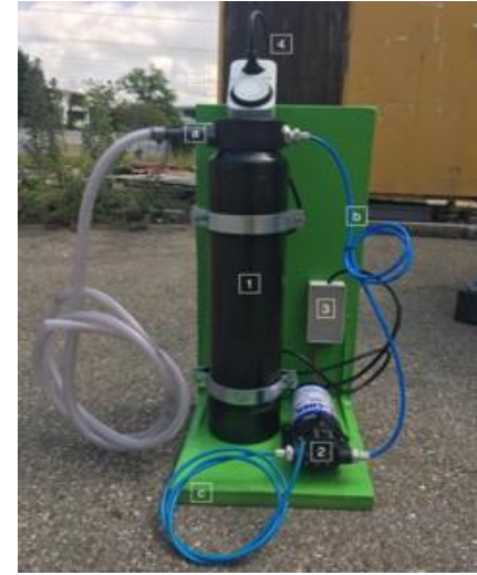
Epuration Filtre à charbon
